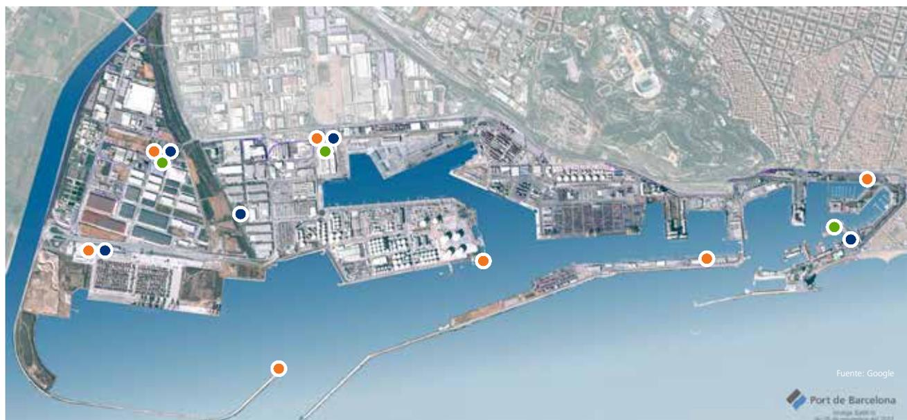
● Estación meteorológica ● Analizador automático ● Captador de alto volumen
