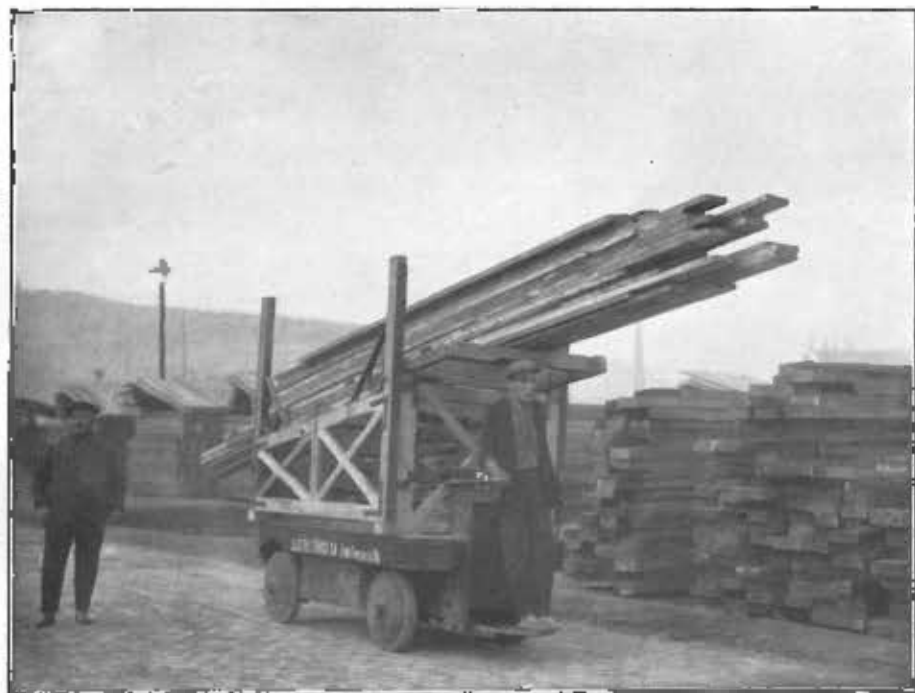
CARRICILLA ELÉCTRICA PARA EL TRANSPORTE DE MADERAS
