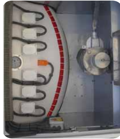
BOCA DE DESCARGA, CON VÁLVULA DE ACCIONAMIENTO LATERAL, TERMÓMETRO Y CONJUNTO DE RESISTENCIAS ELÉCTRICAS
