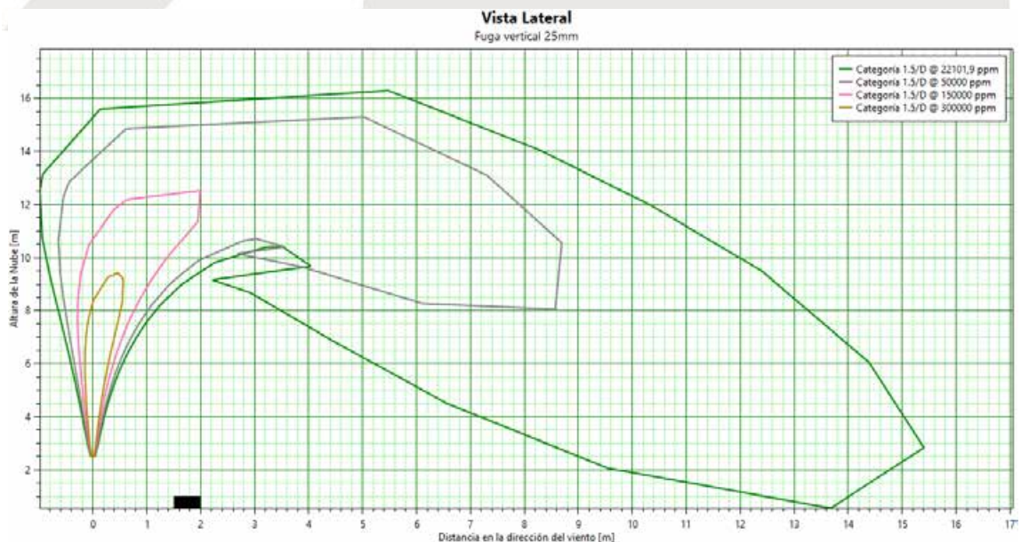
Ilustración 38. Simulación de vista lateral de la nube (en ppm) vs distancia en caso de fuga vertical por un orificio de 25 mm, a 2,5 metros de altura. Clima D – Velocidad del viento 1,5 m/s. Fuente: Elaboración propia con software Phast 7.2
