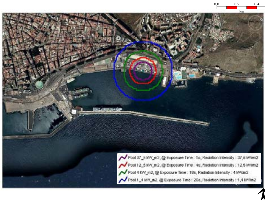
Ilustración 81. Simulación de radiación causada por charco de fuego (en kW/m 2 ) en Terminal de Carga Rodada (TCR) del Puerto de Santa Cruz de Tenerife. Fuente: Elaboración propia con software Phast 7.11
