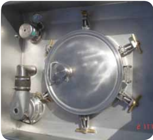
BOCA DE CARGA Y VÁLVULA DE SOBREPRESIÓN CON DISCO DE RUPTURA
