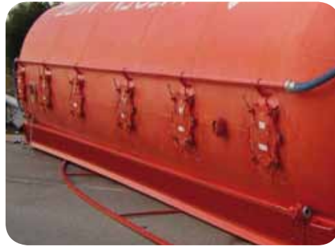
BOCAS DE HOMBRE Y RACORES PARA CARGA
