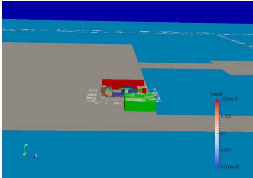
Ilustración 2.98: Alzado fuga horizontal, dentro de los límites de inflamabilidad (0.05 - 0.15), diámetro 40 mm y viento de S-SO.
