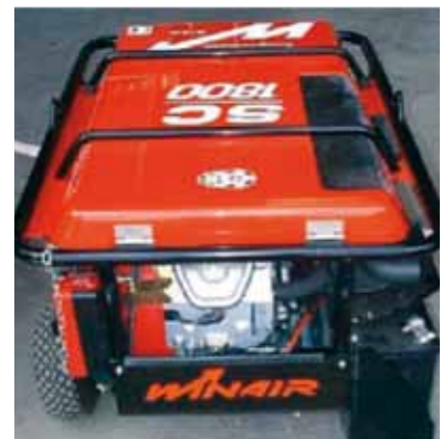
COMPRESOR DE AIRE
