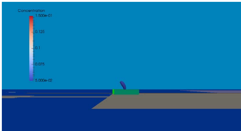
Ilustración 2.1: Alzado fuga vertical, dentro de los límites de inflamabilidad (0.05 - 0.15), diámetro 40 mm y viento de S-SO.
