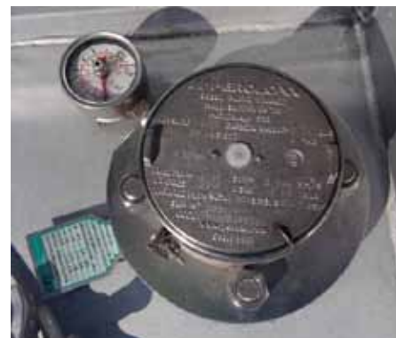
Válvula de sobrepresión para líquidos con disco de rotura
