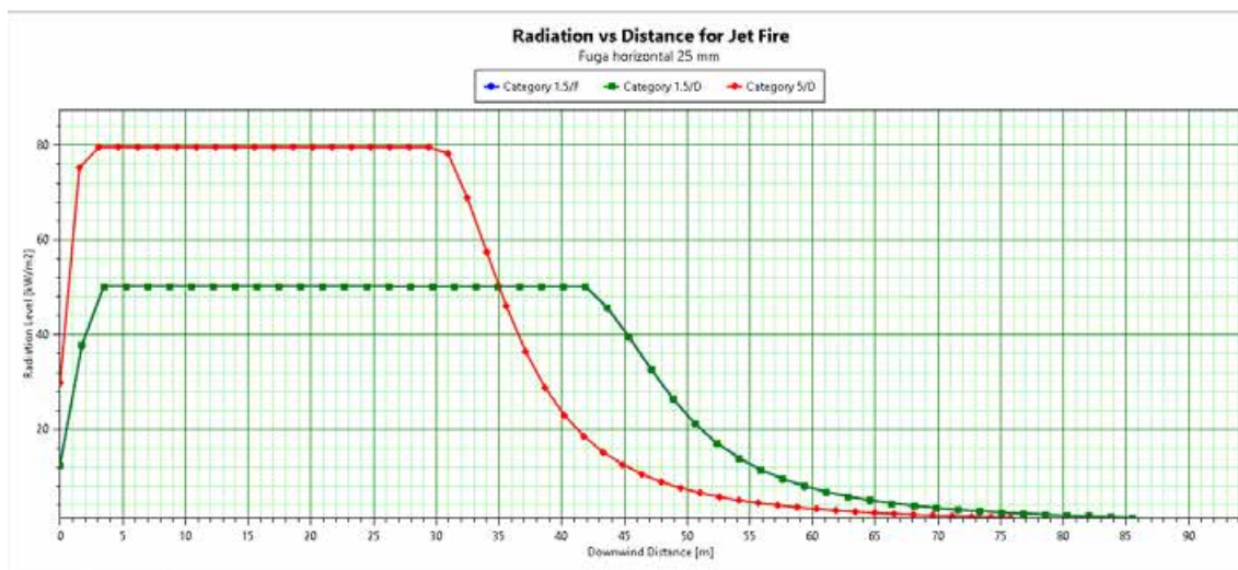
Ilustración 29. Simulación de radiación horizontal vs distancia en caso de chorro de fuego horizontal por un orificio de 25 mm, a 1 metro de altura, para los diferentes escenarios de clima. Fuente: Elaboración propia con software Phast 7.11
