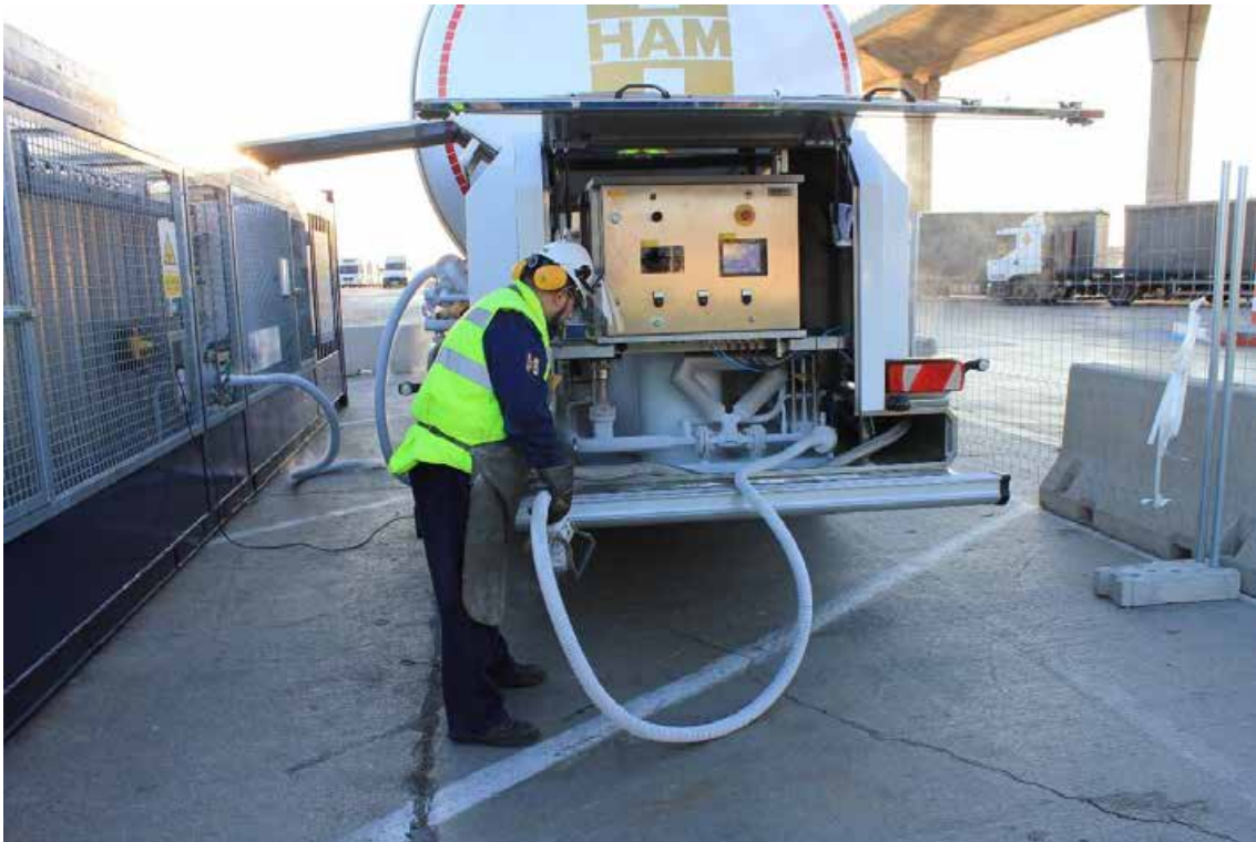
Figura 125. LNG hose disconnection.
