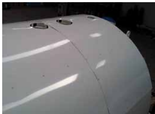
Válvulas de sobrepresión de cisterna de GLP
