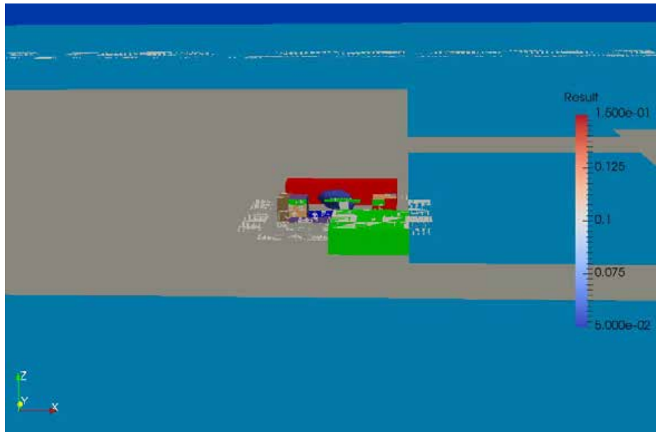
Ilustración 2.102: Alzado fuga horizontal, dentro de los límites de inflamabilidad (0.05 - 0.15), diámetro 40 mm y viento de N-NE
