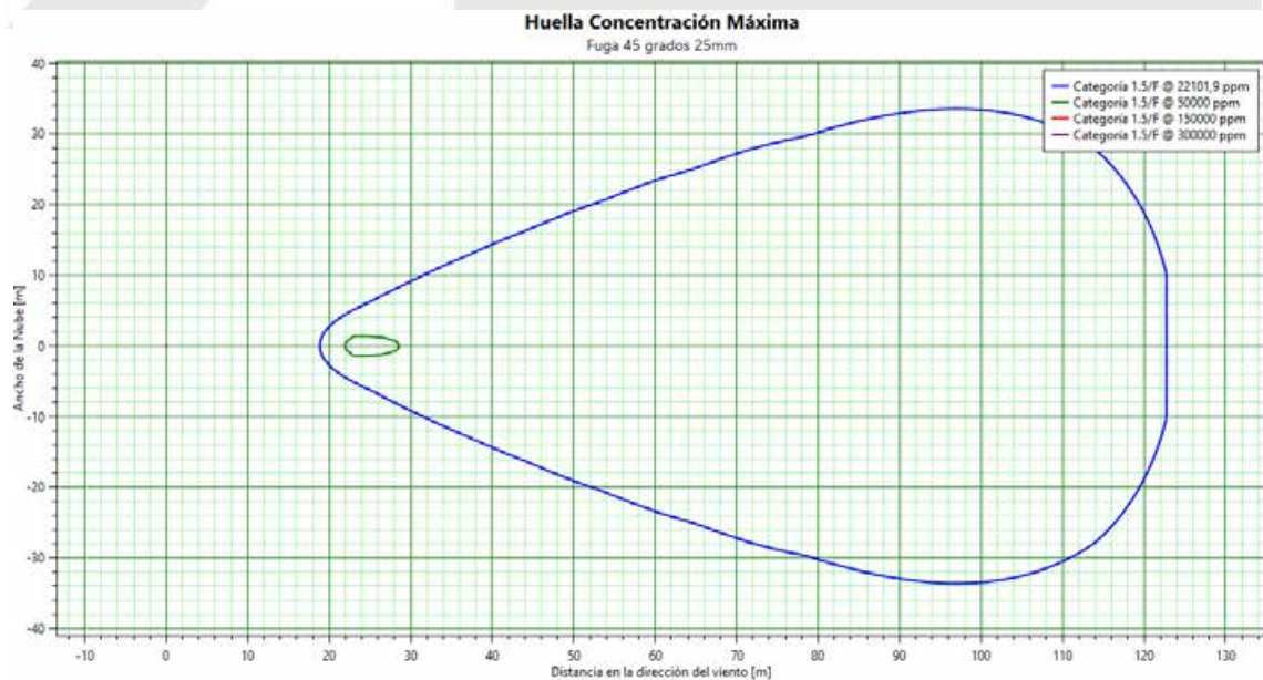
Ilustración 58. Simulación de impresión máxima de la nube vs distancias en caso de fuga inclinada 45 grados por un orificio de 25 mm, a 0,30 metro de altura. Altura de interés: 0 m. Clima F – Velocidad del viento 1,5 m/s. Fuente: Elaboración propia con software Phast 7.2
