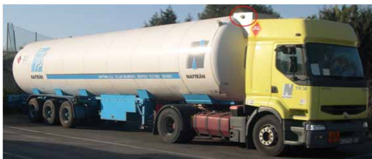
Fig. 8. Vista del armario delantero superior donde se alojan las válvulas de seguridad y por donde sobresale (dentro del círculo rojo) el tubo de venteo en una cisterna monocasco para el transporte de GNL de diseño antiguo. (Foto autor)
