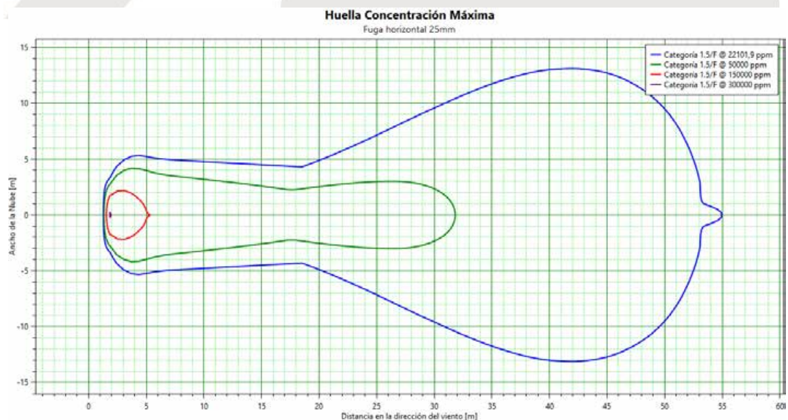
Ilustración 18. Simulación de impresión máxima de la nube vs distancias en caso de fuga horizontal por un orificio de 25 mm, a 0,30 metro de altura. Altura de interés: 0 m. Clima F – Velocidad del viento 1,5 m/s. Fuente: Elaboración propia con software Phast 7.2
