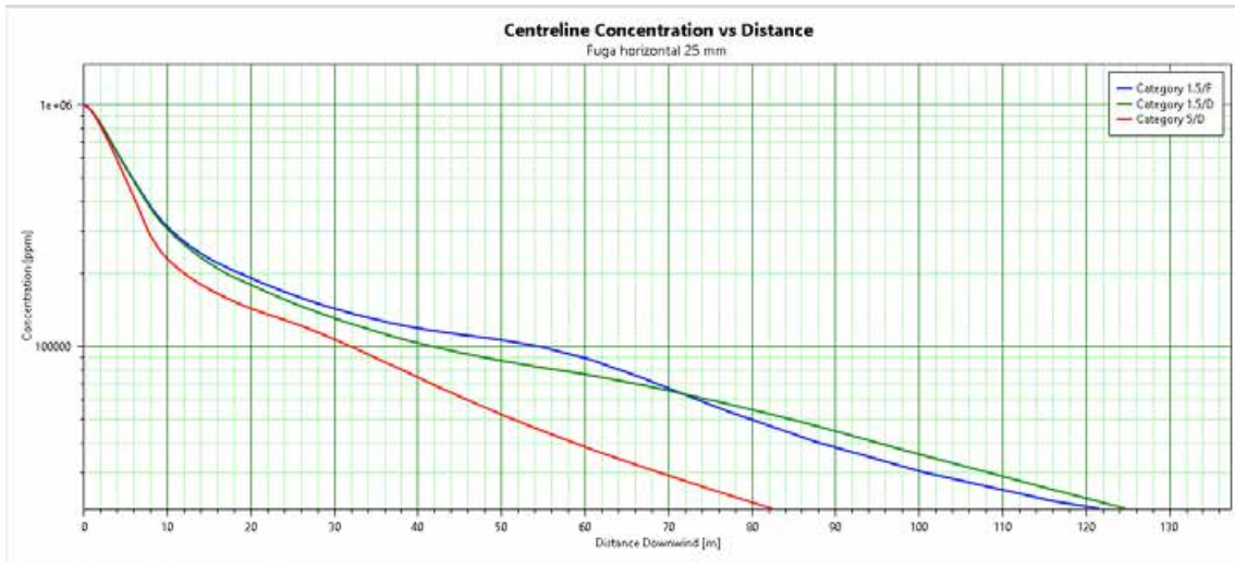
Ilustración 7. Simulación de concentración media (en ppm) vs distancia para las tres categorías climatológicas en caso de fuga horizontal por un orificio de 25 mm, a 1 metro de altura. Fuente: Elaboración propia con software Phast 7.11
