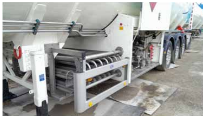
Fig. 45. En primer término, PPR incorporado a un camión cisterna para GNL. (Foto cortesía de ESK)
