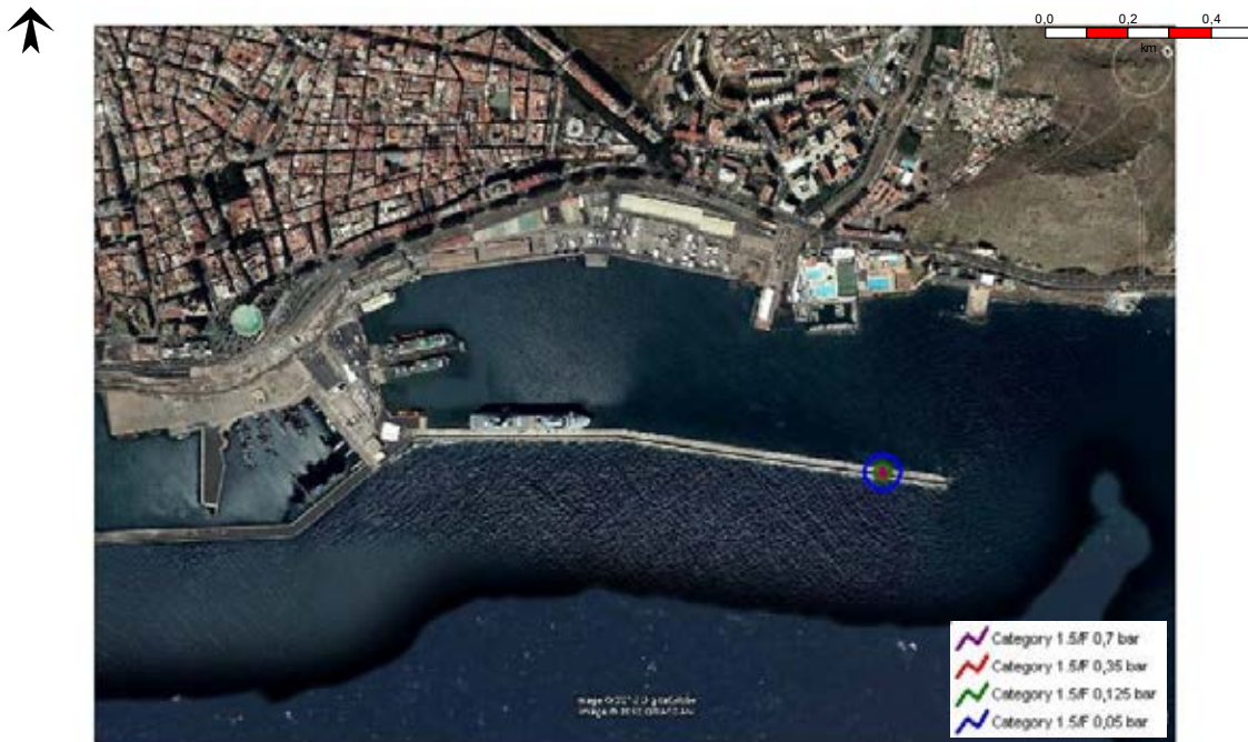
Ilustración 92. Simulación de sobrepresión para daños a personas (en bar de sobrepresión) causada por BLEVE en Dique Muelle Sur del Puerto de Santa Cruz de Tenerife. Fuente: Elaboración propia con software Phast 7.11
