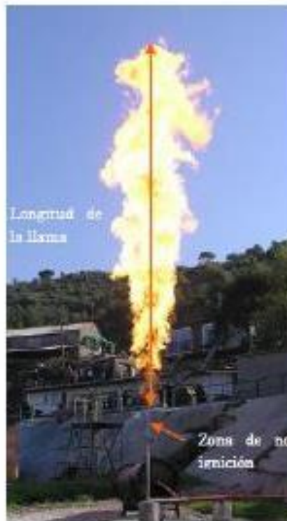
Ilustración 23. Incendio de chorro bifásico (propano). Fuente: Tesis doctoral “ Estudio de la dispersión e incendio de nubes inflamables de gas (GNL y GLP) ” de la Doctora: Diana Villafañe Santander – 2013
