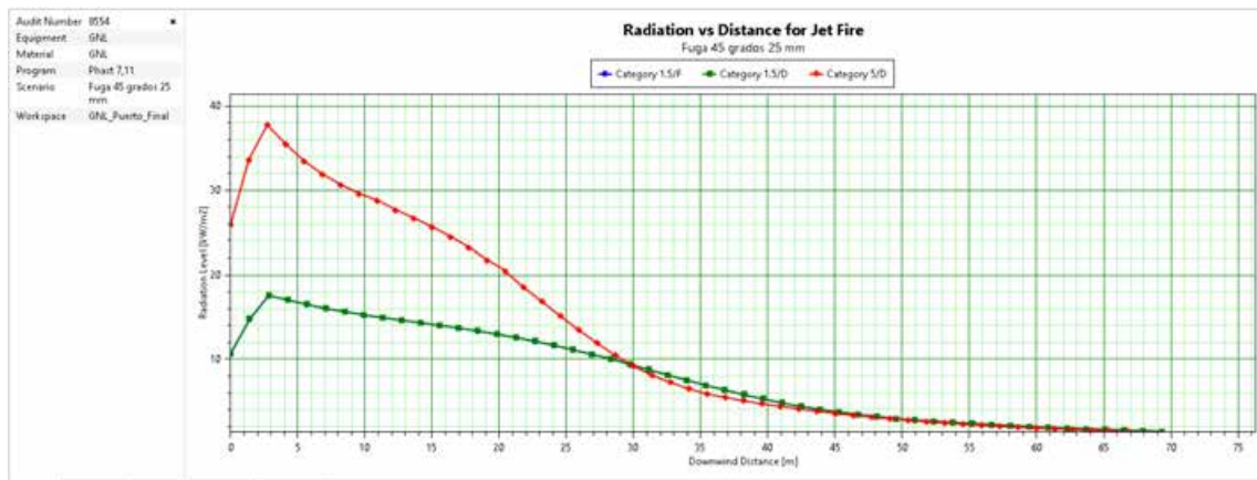
Ilustración 78. Simulación de radiación vs distancia en caso de chorro de fuego inclinado 45 grados por un orificio de 25 mm, a 1 metro de altura, para los diferentes escenarios de clima. Fuente: Elaboración propia con software Phast 7.11
