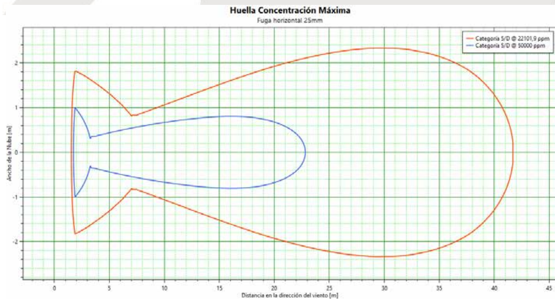
Ilustración 20. Simulación de impresión máxima de la nube vs distancias en caso de fuga horizontal por un orificio de 25 mm, a 0,30 metro de altura. Altura de interés: 0 m. Clima D – Velocidad del viento 5 m/s. Fuente: Elaboración propia con software Phast 7.2
