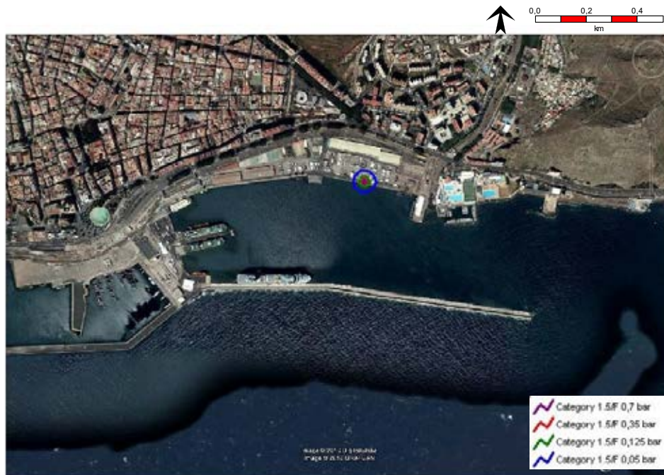
Ilustración 82. Simulación de sobrepresión para daños a personas (en bar de sobrepresión) causada por BLEVE en Terminal de Carga Rodada (TCR) del Puerto de Santa Cruz de Tenerife. Fuente: Elaboración propia con software Phast 7.11
