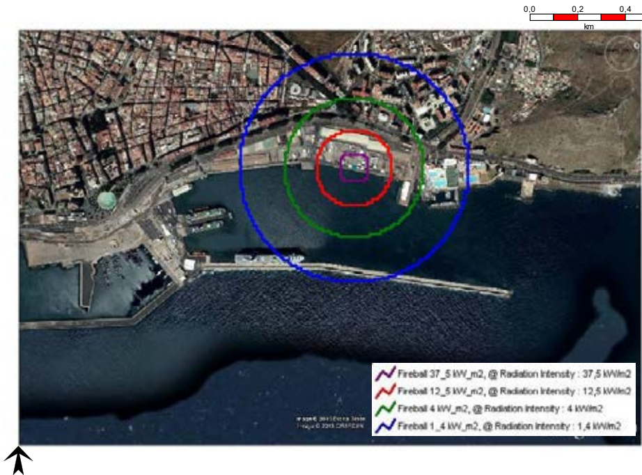
Ilustración 79. Simulación de radiación causada por bola de fuego (en kW/m 2 ) en Terminal de Carga Rodada (TCR) del Puerto de Santa Cruz de Tenerife. Fuente: Elaboración propia con software Phast 7.11
