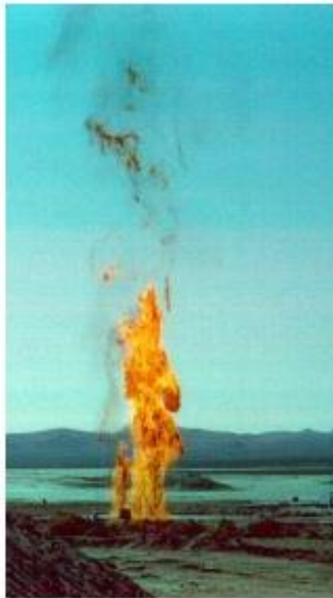
Ilustración 22. Incendio de charco realizado durante la serie de pruebas en China Lake. Fuente: Tesis doctoral "Estudio de la dispersión e incendio de nubes inflamables de gas (GNL y GLP)" de la Doctora Diana Villafañe Santander – 2013
