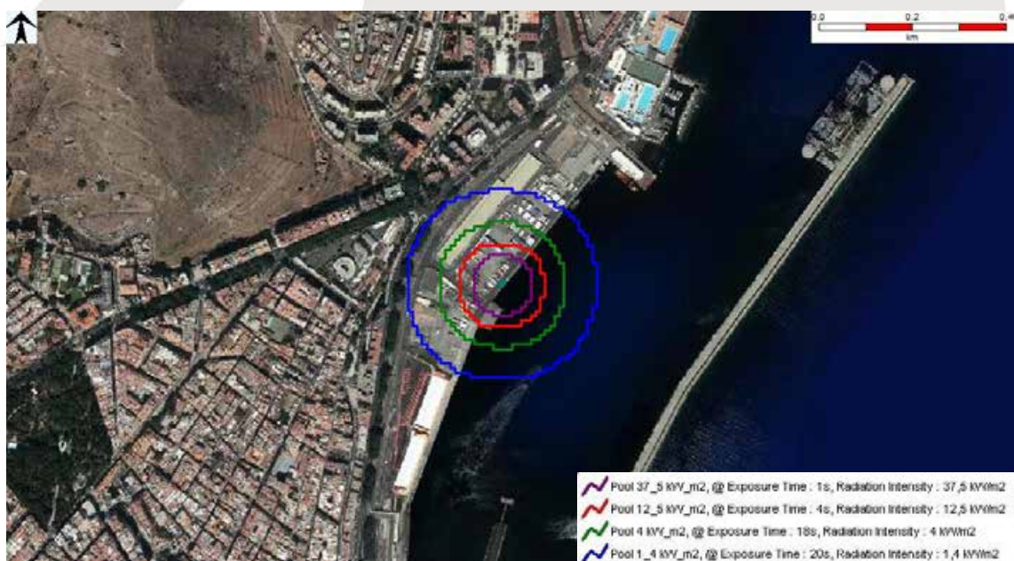
Ilustración 82. Simulación de radiación causada por charco de fuego (en kW/m 2 ) en Terminal de Cruceros del Puerto de Santa Cruz de Tenerife. Fuente: Elaboración propia con software Phast 7.2
