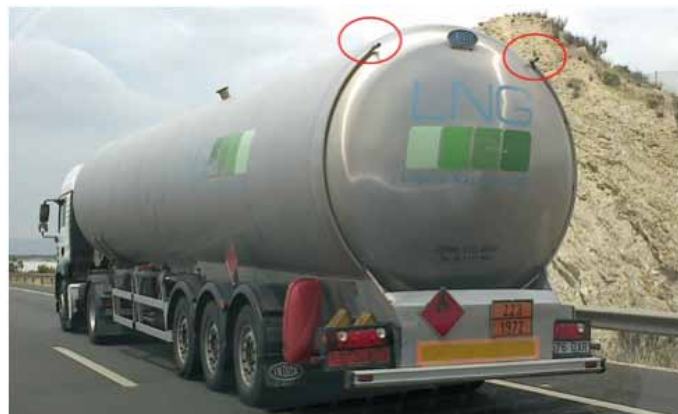
Fig. 7. Apagallamas o dispositivos de venteo en una cisterna para transporte primario aislada al vacío para GNL (Foto autor)
