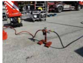
Compresor y regulador de presión
